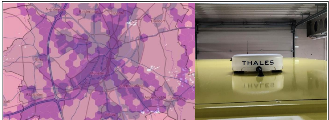
Abbildung 7: Bei schlechter GSM-Netzabdeckung: Lösung ist Satcom hier eine Antenne auf dem RTW
